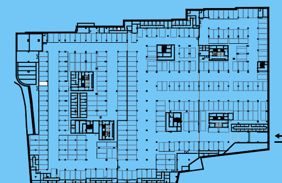
PLANTA PISO ESTACIONAMENTO -2 | PARKING FLOOR -2
