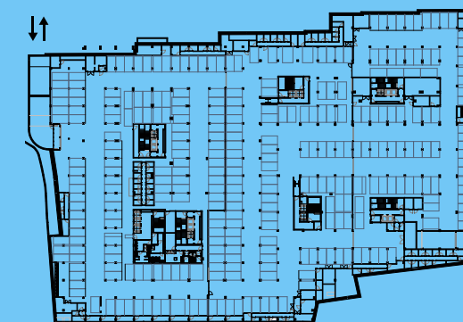
PLANTA PISO ESTACIONAMENTO -1 / PARKING FLOOR -1
